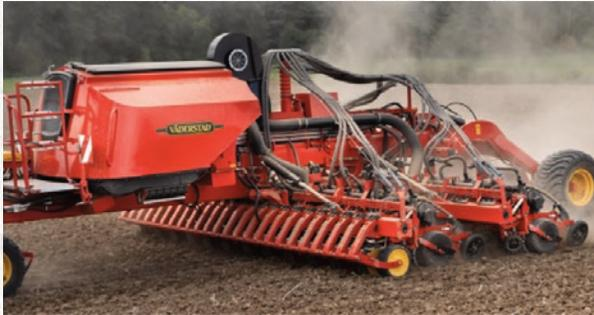
Lorsque les graines arrivent de la trémie centrale aux éléments semeurs, une version adaptée du système de distribution Väderstad « PowerShoot », présent sur les semoirs monograines Tempo, prend le contrôle total de chaque graine jusqu'au sol. En quittant le tube court de descente, chaque graine est plaquée dans le sol grâce à la roue de rappuie. Cela garantit un contact optimal entre la graine et le sol à la profondeur réglée et cela sur toute la largeur de travail.
